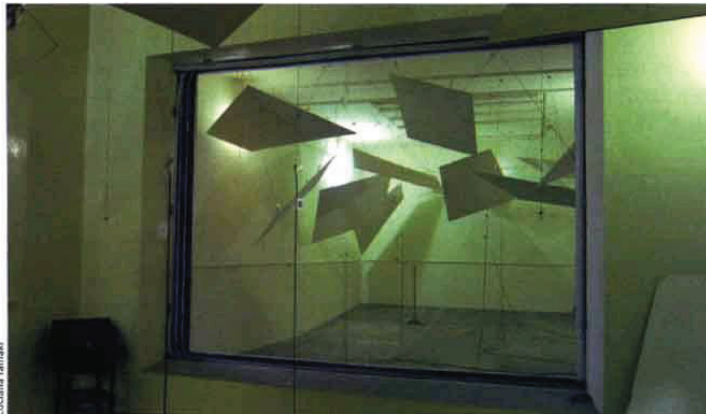
Tanto o elemento absorvedor, como um forro, ou mesmo divisórias inteiras podem ter sua absorção ou isolamento respectivamente medidos, como no laboratório do IPT
