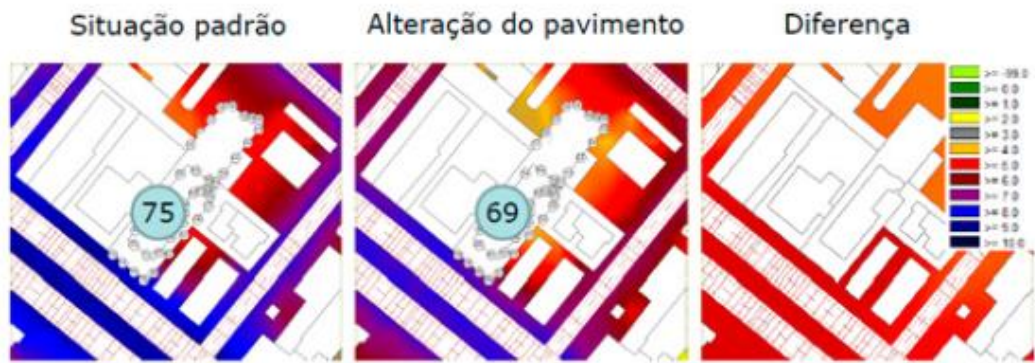
Figura 6: Estudo de caso com alteração do pavimento de uma via. Da esquerda para a direita: Mapa da situação padrão, Mapa com medida aplicada e Mapa da diferença.
