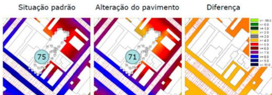
Figura 5: Estudo de caso com alteração do pavimento de uma via. Da esquerda para a direita: Mapa da situação padrão, Mapa com medida aplicada e Mapa da diferença.
