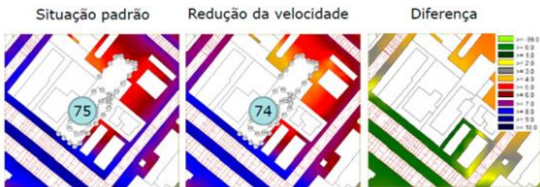
Figura 4: Estudo de caso com alteração da velocidade de uma via. Da esquerda para a direita: Mapa da situação padrão, Mapa com medida aplicada e Mapa da diferença.
